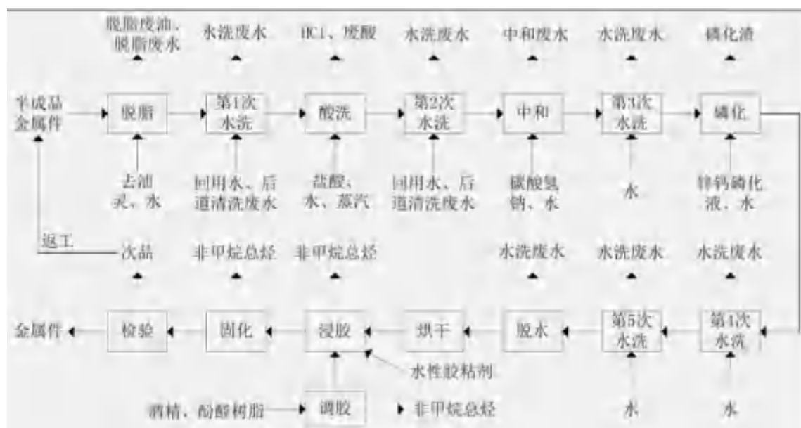
图 3-6 骨架制造（表面处理—老项目技改）生产工艺流程及产污节点图
