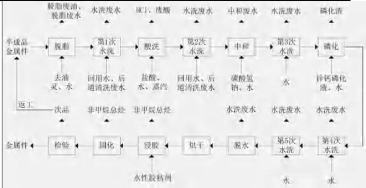
图 3-7 骨架制造（表面处理—本项目新增）生产工艺流程及产污节点图
